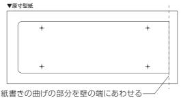
※曲げのスペースができるよう、原寸型紙は 銘板右端から - 15mmのサイズ で記載されています
